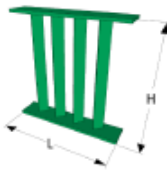
Striphekwerk Vulling strip < 70x8 mm h.o.h. min. 100 mm L x H Vulling strip ≥ 70x8 mm h.o.h. min. 100 mm L x H x 1,50 Tenzij het verfooppvlak meer is.
